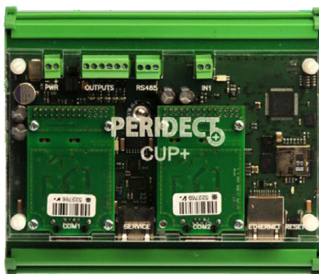
Блок управления CUP+, вид спереди
