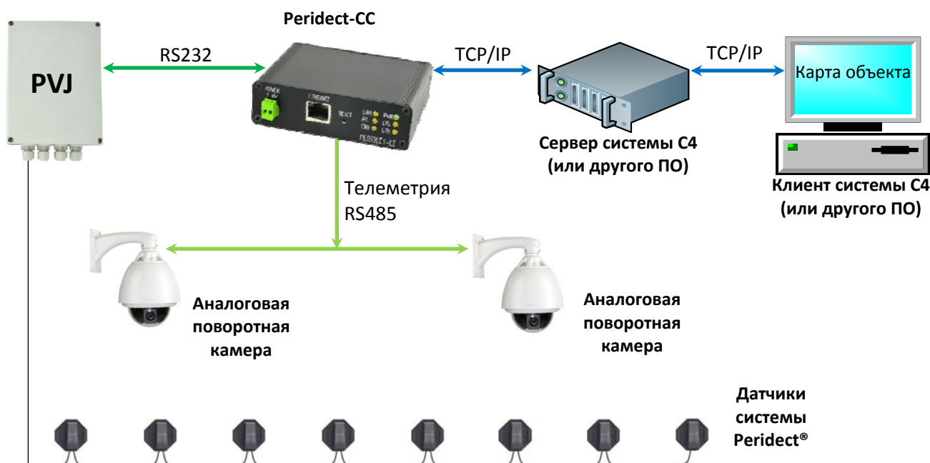
Типовая схема подключения модуля Peridect-CC
